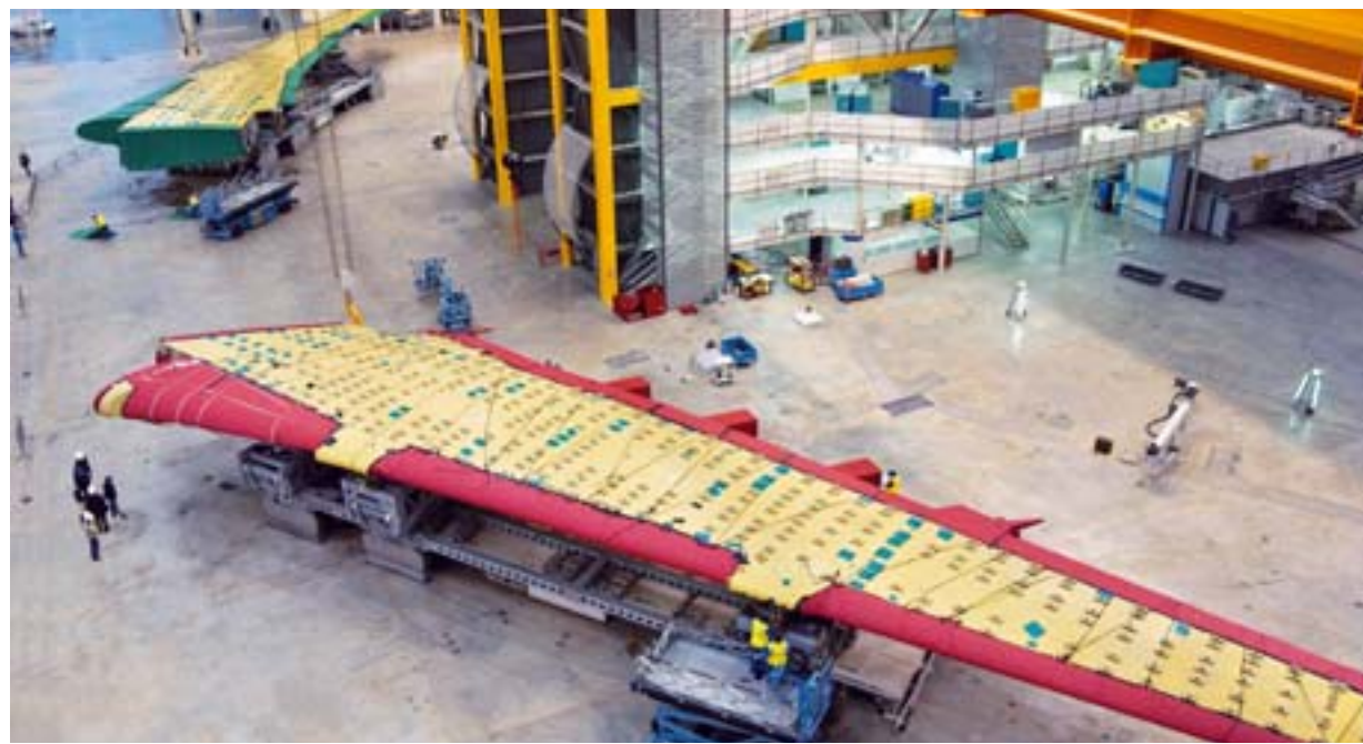
Die je 26 m langen Tragflächenkanten des A 380 sowie die Rippen und Profile der Kielversteifung sind aus carbonfaserverstärkten PPS-Kompositen gefertigt Bild: Ticona
