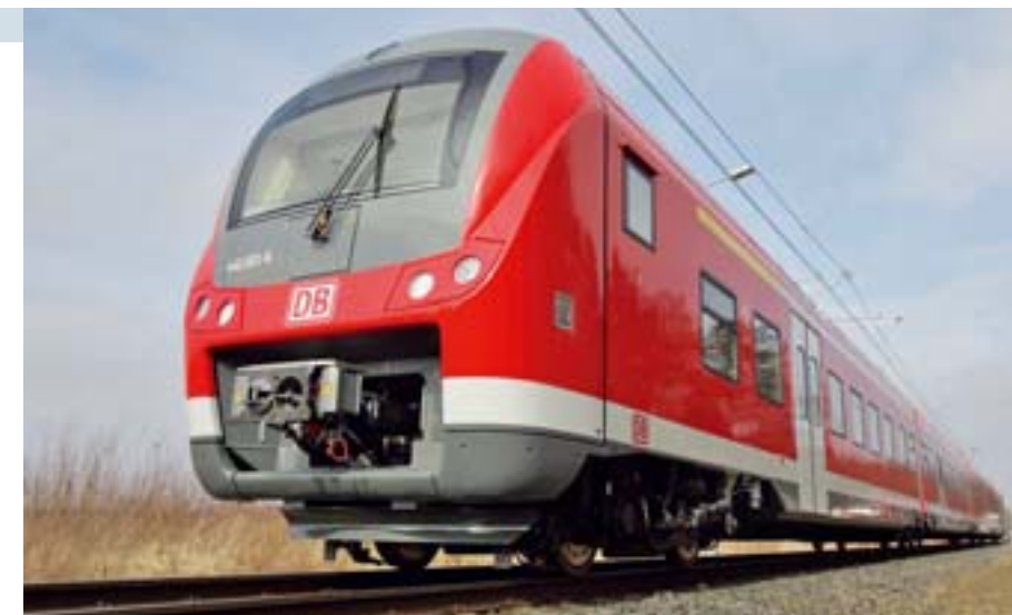
Beim Nahverkehrszug Coradia Lirex sind die Front- und Dachverkleidung aus glasfaserverstärkten Duroplasten gefertigt, ebenso wie WC-Seitenteile und Luftsaulenverkleidungen Bild: Alstom LHB
