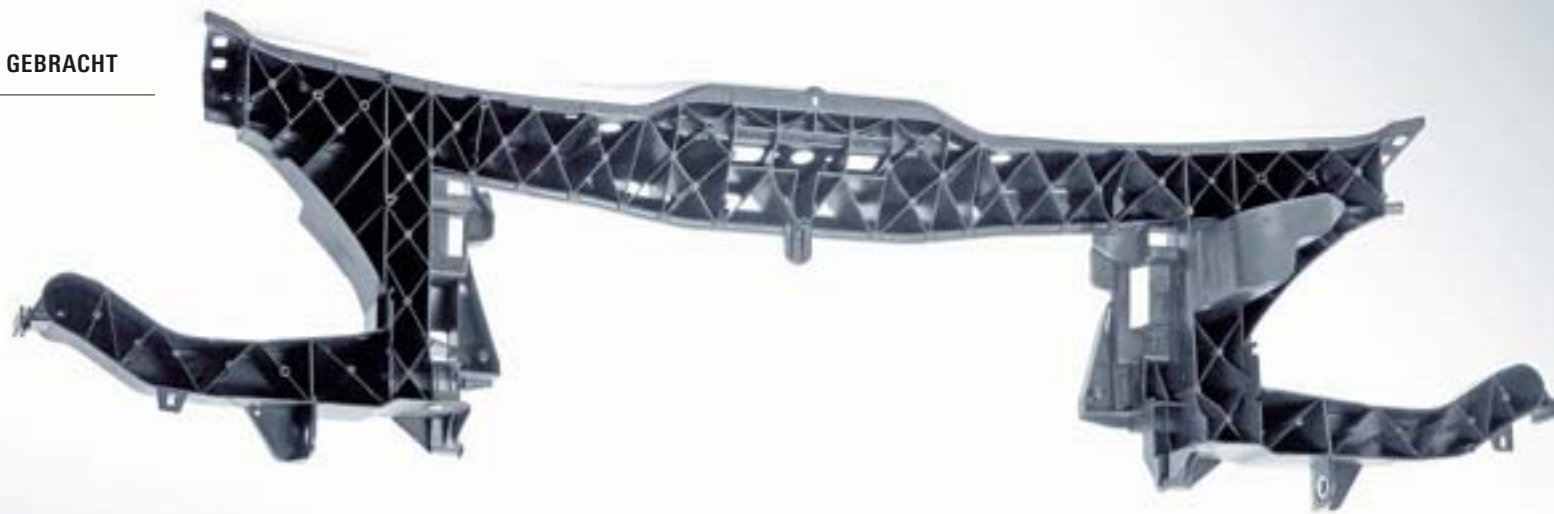
Tragende Frontend-Struktur beim Mercedes Benz Vito/Viano NCV2, spritzgegossen aus langfaserverstärktem Polypropylen (PP-LFT) Bild: Ticona
